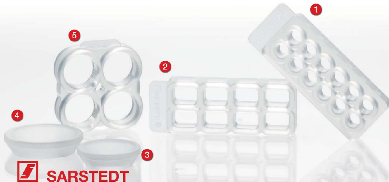
quadriPERM® – Microplaca de cultivo celular para ensayos en paralelo
