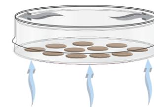
Fig. 4 En los recipientes convencionales para cultivo celular no se produce ningún intercambio gaseoso a través del fondo de vidrio o poliestireno
